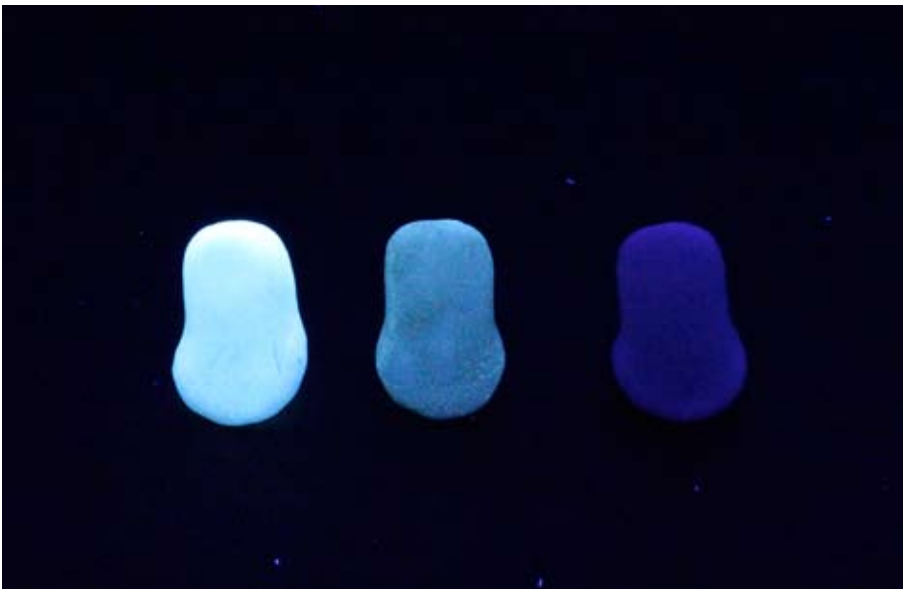
Kuva 18. Fluoresoivalla massalla käsitelty zirkoniahetta loistaa UV-valon alla kuin halogeenilamppu. Valmistajan linerilla käsitelty hetta fluoresoi kevyesti. Käsittelemätön zirkoniahetta ei fluoresoi lainkaan.
