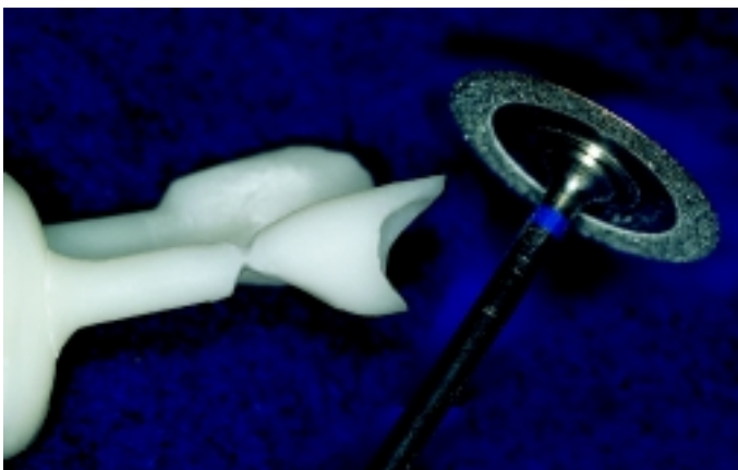
Kuva 12 Irrottaessasi rungot valukanavista käytä karkeaa timanttilaikkaa, välttä kuumenemista katkaisemalla kanavat suorassa linjassa. Hio kanava molemmilta puolin poikki. (kuvassa Edenta™ Superflex timanttilaikka)
