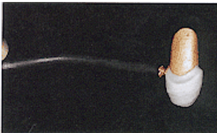
Kuva 3. Grammin laitteella galvanoitu kultarunko kuparijohtimen kanssa.
