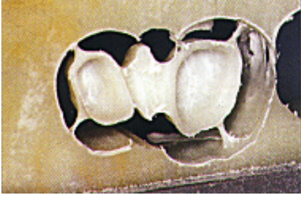
Sillan muovirunko jyrinnän jälkeen
