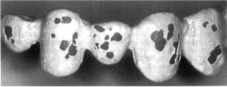
Kuva 1. Moniosainen etuhammassilta ensimmäisen keramiikkapolton jälkeen kun perusmassassa on ollut kuplia.
