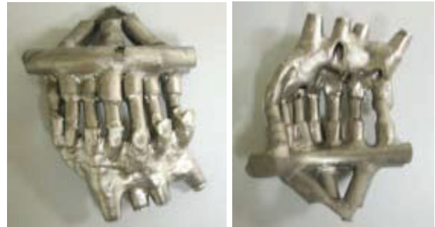
Kuvat 12 ja 13. Työ valun jälkeen. Kanavat vielä kytkettynä.
