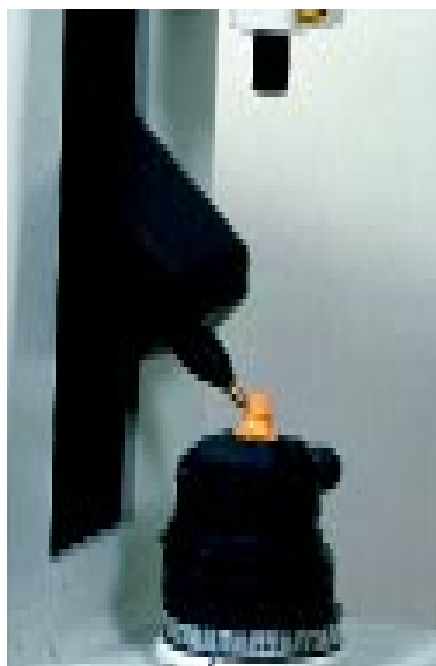
kuva 1 kipsitapin lukeminen skannerissa
