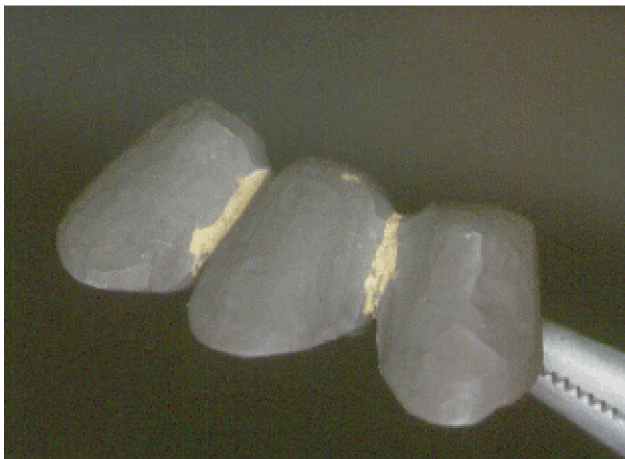
Kuva 1 Tutkittava silta. Virhepinta näkyy keskimmäisen kruununreunassa oikealla.
